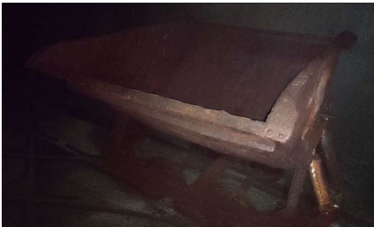
Figura 4 – Carrello per la movimentazione del materiale di scavo dentro la galleria Bracco Giorgio.
